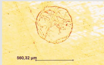
由垫片D造成的测量面积显微图
