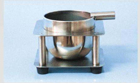
测量金属丝和小部件的电解杯
