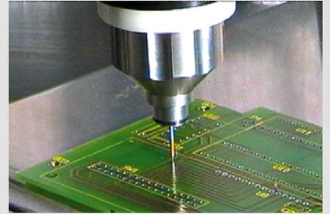
小面积上定位电解池的定位器
