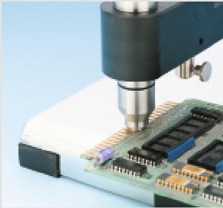
典型测量：测量PCB上的镀金层厚度
