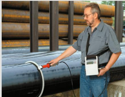
管道孔隙率检测
