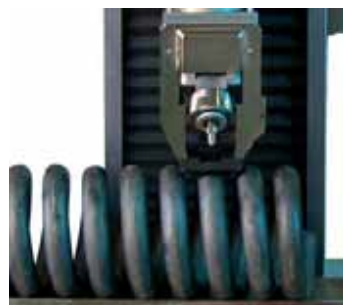
X-Y自动工作台，尺寸：200x100mm，走位精度：0.01mm，用于自动测量硬化层深度，可手动控制或编程控制。
